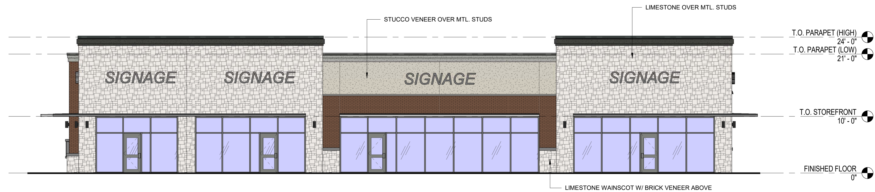
1 FRONT ELEVATION SCALE: 1/8" = 1'-0"
